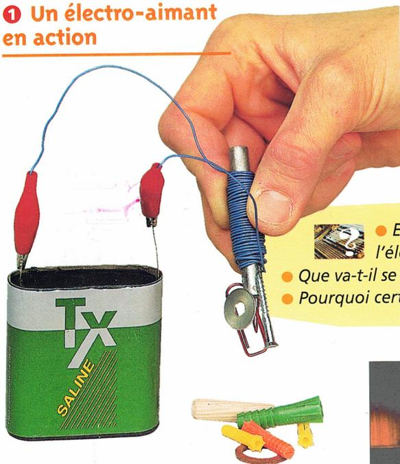
Un électro-aimant est constitué d'une bobine de fil électrique enroulé autour d'un barreau de fer appelé noyau. Quand le fil est parcouru par du courant électrique, le noyau de fer devient fortement aimanté. Dès qu'il n'y a plus de courant qui circule, le noyau perd son aimantation.
